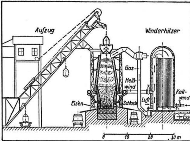
Bild 1. Schematische Darstellung einer Hochofenanlage
