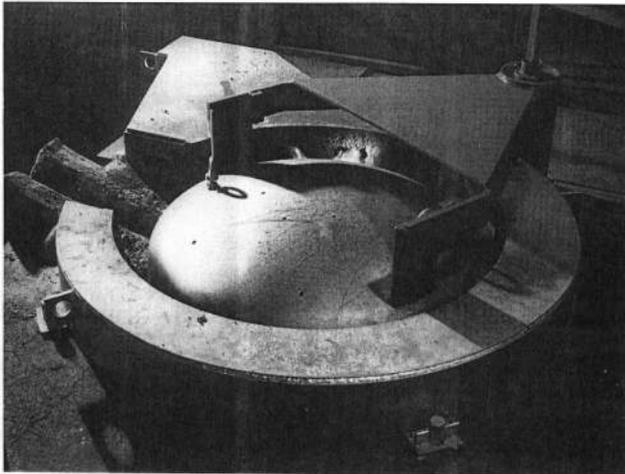
**Bild 7: MF-Ind.-Tiegelofen mit Tiegelrandabsaugung**
