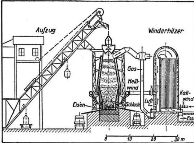
Bild 1. Schematische Darstellung einer Hochofenanlage
