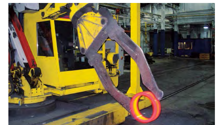
Andromat AMX 40 mit Fahrwerk im Schmiedeeinsatz
